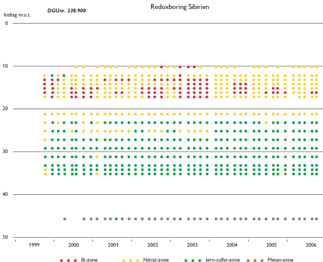
Figur 25. Redoxzoner 10-46 m.u.t for redoxboring DGU nr. 238.900, Sibirien, på Falster, Miljøcenter Nykøbing Falster 2000-2006. Grundvandsspejl i ca. 8-9 mut.
